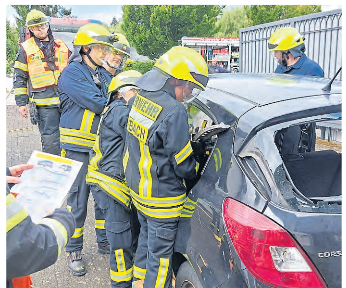
Am schwarzen PKW wird anhand des Rettungsdatenblattes des Herstellers das Dach mit der hydraulischen Rettungsschere abgetrennt, um die Fahrerin retten zu können.
