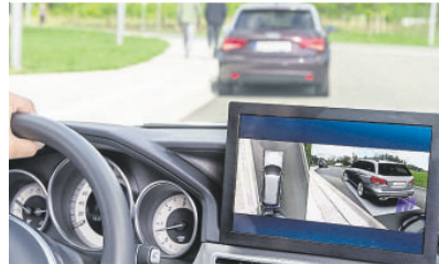
Kameras rund um das Fahrzeug erleichtern das Rangieren in engen Parklücken. Foto: djd/Bosch
